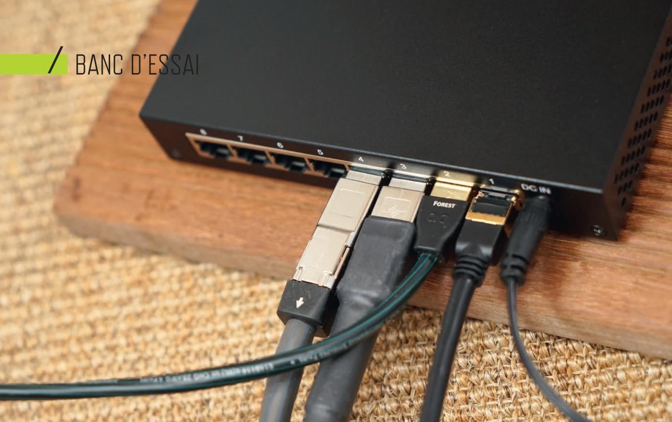
Le Bonn N8 comprend deux circuits d'isolation de bruit électrique pour le circuit d'alimentation, avec un taux de réjection de bruit de 17 dB, ainsi que deux circuits d'isolation de bruit électrique pour le circuit d'horloge, avec un taux de réjection de bruit de 20 dB. Grâce à ces circuits d'isolation de bruit, le Bonn N8 fonctionne de façon ultrastable, ce qui génère des signaux de réseau propres.
